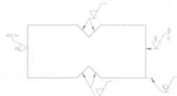
Figura 8.28 - Orientação dos símbolos de acabamento de acordo com a orientação da folha de desenho.
